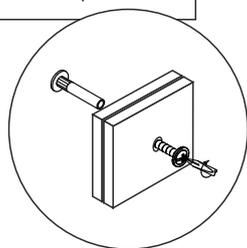
Для этого просверлить в боковинах 4 навесной полки и боковинах соседний модулей на расстоянии около 10-15 см от каждого угла стенок сквозные отверстия диаметром 5 мм на одном уровне. Гайки стяжек входят в отверстие, и крепеж свинчивается.
